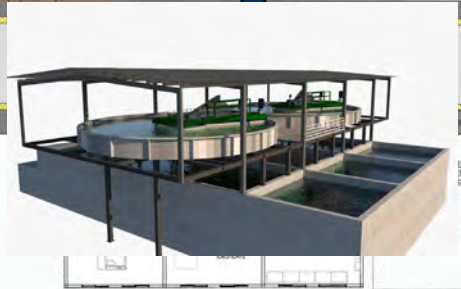
FLOTACION POR AIRE DISUELTO
